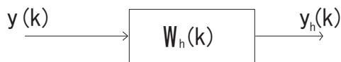
Fig. 3 パワースペクトル・HPF法ブロック図 検出したい。ハウリング検出には、パワースペクトル・HPF (High Pass Filter) 法を提案する。これは、周波数の関数 ( k ) である離散フーリエ変換 (DFT) の振幅スペクトルを時間の関数 ( n ) と考え、フィルタ処理を施す方法である。入力信号を x(n) 、その DFT を X_s(k) としたとき、
