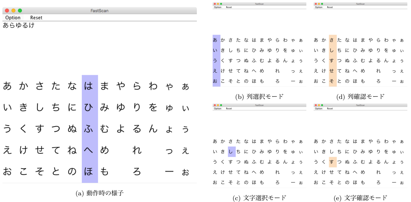
図 7: 実装した文字走査入力システム
